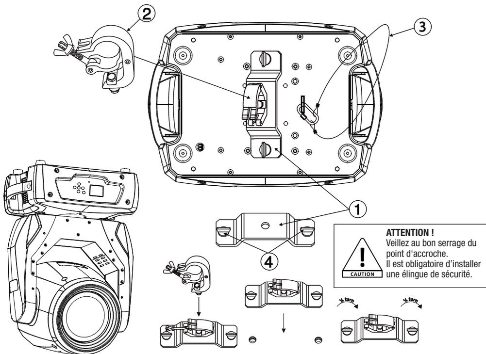
La lyre Evora-B2R est fournie avec un systèmes QuickLock qui vous garantis des manipulations rapides. L'exemple ci-contre vous montre le principe de montage de la fixations Omega.
